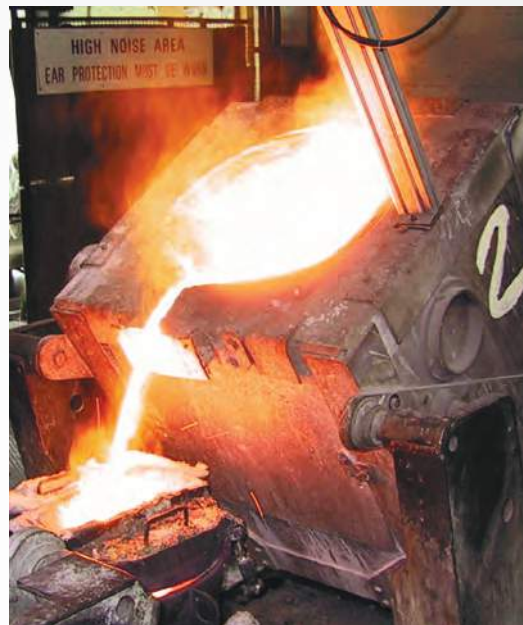
Coulée dans un four d'atomisation.
