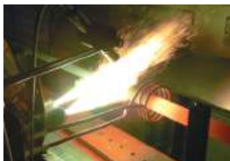
Projection avec refusion induction.
