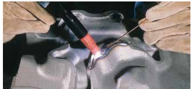
1) Gasdüse - 2) Schutzgas - 3) Zusatzwerkstoff 4) Schweißbad - 5) Schweißgut - 6) Grundwerkstoff
