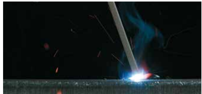
1) Stabelektrode - 2) Ummantelung - 3) Kernstab 4) Lichtbogen - 5) Schutzgas - 6) Schweißbad - 7) Schlacke 8) Schweißgut - 9) Grundwerkstoff
