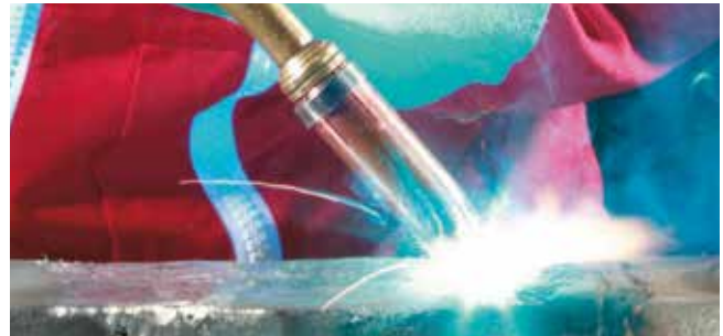
1) Schutzgasdüse - 2) Kontaktdüse - 3) Massivdraht- oder Fülldrahtelektrode 4) Schutzgas - 5) Lichtbogen- 6) Schweißbad - 7) Schweißgut 8) Grundwerkstoff
